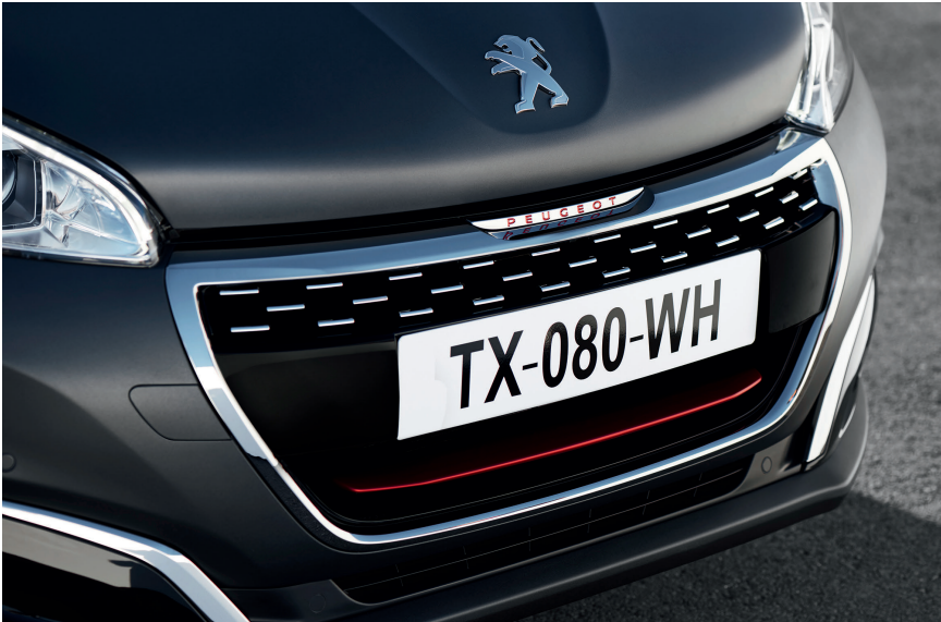
Bild 1. Einige französische Automobilhersteller setzen bereits auf Bauteile auf Chrom(III)-Basis, wie hier beim Kühlergrill des Peugeot 208 © Groupe PSA
